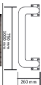
Rammschutzbügel doppelseitig, vertiefte Aus- fuhrung ca. 260 mm
