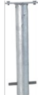
Bodenhülse, anschraub- bar an alle Bodenplatten. Lochabstd.: 70 x 122 mm Fundament: ca. 250 x 250 mm
