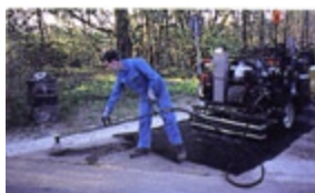
Schnelle Selbstbefüllung des 800-l-Kessels mittels Saugrohr und Pumpe
