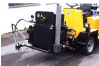
Vorbau-Bitumenkocher zur Rand- und Arbeitsnahtbehandlung
