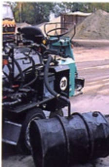
Schnelle Selbstbefüllung des 800-l-Kessels mittels Saugrohr und Pumpe
