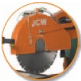
Schutzhaube bleibt immer waagrecht zum Rolltisch
