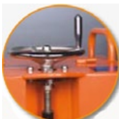
Handgriff für Tiefeneinstellung mit Schnitttiefenanzeiger
