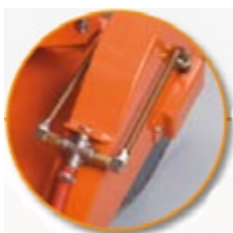
Beidseitig regulierbare Wasserzufuhr
