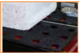
Rolltisch mit rutschfester Gummiauflage
